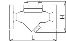
注:呼び径32~50のL寸法はJIS 20K RF法兰の値です。
