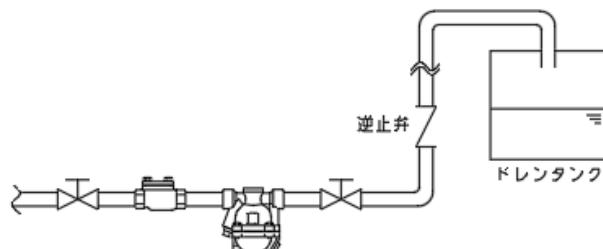
5) トランプの排出側をドレン回収管に導く場合は、ドレン回収管の上側に接続してください。
