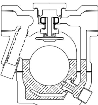
蒸気を通すと、トラップ内に空気とドレンが蒸気に押されて入り、空気は空気抜弁から出口側へ排出されます。
