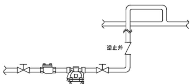
6) 蒸気主管に取付ける場合は、主管と同径のダートポケットを設けてください。
