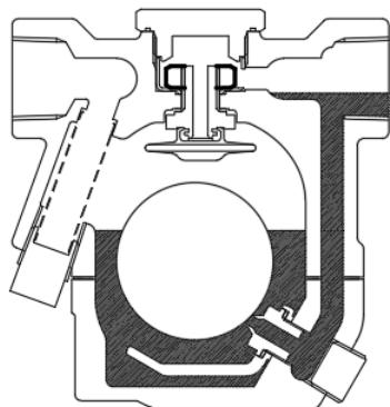
ドレンが流入しますと水位が上昇し、その分フロートが浮き上がり弁開状態となります。
