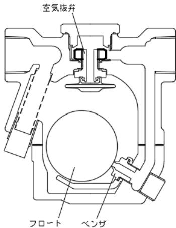
蒸気を通す前は、フロートは下がった状態にあり弁閉しています。
