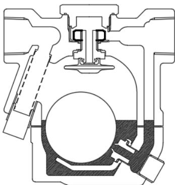
空気、ドレンが排出された後、蒸気が流入しトラップの温度が上昇することにより、空気抜弁が感温し弁閉します。
