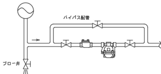
4) トランプの排出側をドレンタンクなどに入れる場合は、出口配管の端を水没させないでください。
