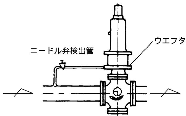
ニードル弁は一次側圧力が変動（脈動を起す）する場合に少し絞り、圧力を安定させるために取付けます。（但し、ニードル弁は完全閉止させないでください。完全閉止の状態では一次圧力調整弁は正常に作動しません。）
