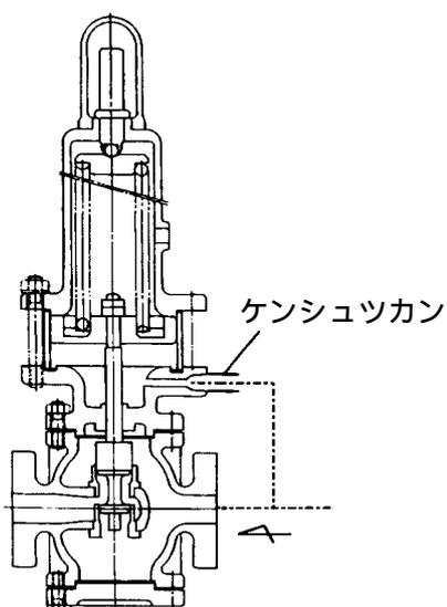
一次側から流入した流体の一部は、ケンシュツカンを通してピストンの下部に達し、上向きの力として働きます。流体圧力が上昇し、設定圧力を越えると、ピストンの下部に作用する上向きの力がチョウセツバネ荷重などの下向きの力に打ち勝って、ピストンを押し上げ、弁開し、一次側圧力の上昇を防ぎます。
