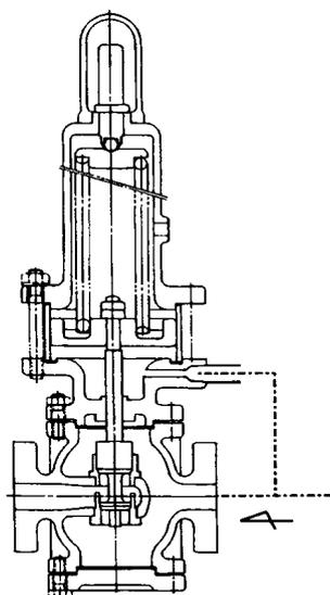
一次側圧力が設定圧力以下になると、ピストンに作用する上向きの力よりもチョウセツバネ荷重などの下向きの力の方が上回り、弁閉し、一次側圧力の降下を防ぎます。このように一次側の圧力変動に応じ、弁の開度を調節して、一次側の圧力を一定に制御します。
