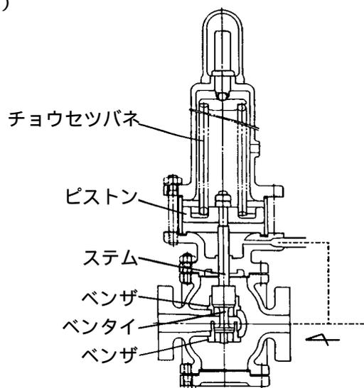
流体を流さない状態では、一次圧力調整弁はチョウセツバネ、ピストン、ステムなどの部品質量とチョウセツバネ荷重（下向きの力）によりベンタイはベンザに押しつけられ、弁は閉じています。
