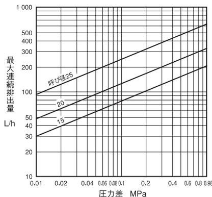
1. 呼び径を選定する場合、安全率をみて、計画排出量の2倍以上の容量で選定してください。
