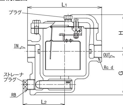
注. 本製品は、内部にドレン流入をスムーズにするよう、通常時バケットの上下動による多少の空気排出 (5L/min程度) がありますので、ご注意ください。
