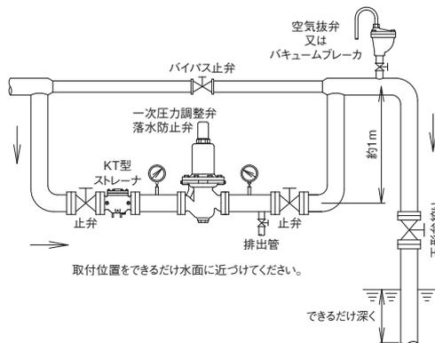
図2. 一次圧力調整弁・落水防止弁(バイパス配管なし)
