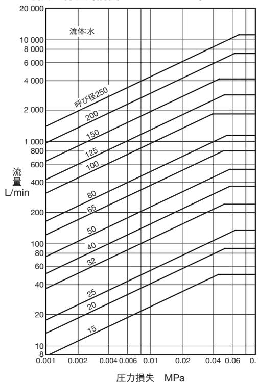
注. 各メッシュの圧力損失は、線図で求めた圧力損失に乗数を乗じて算出してください。
