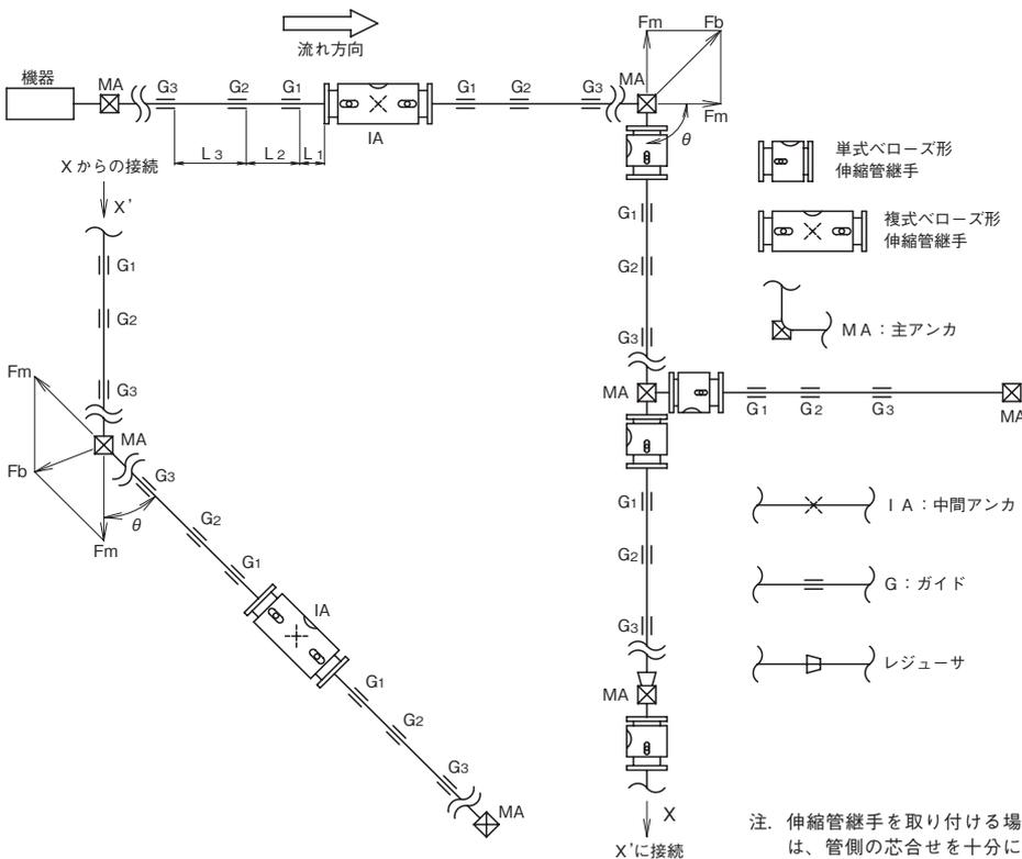
注. 伸縮管継手を取り付ける場合は、管側の芯合せを十分に行い、取り付けてください。
