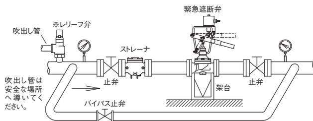
※液体用の場合、ハンマー現象や周囲温度による流体の熱膨張などで昇圧が予想される場合は、レリーフ弁を取り付けてください。
