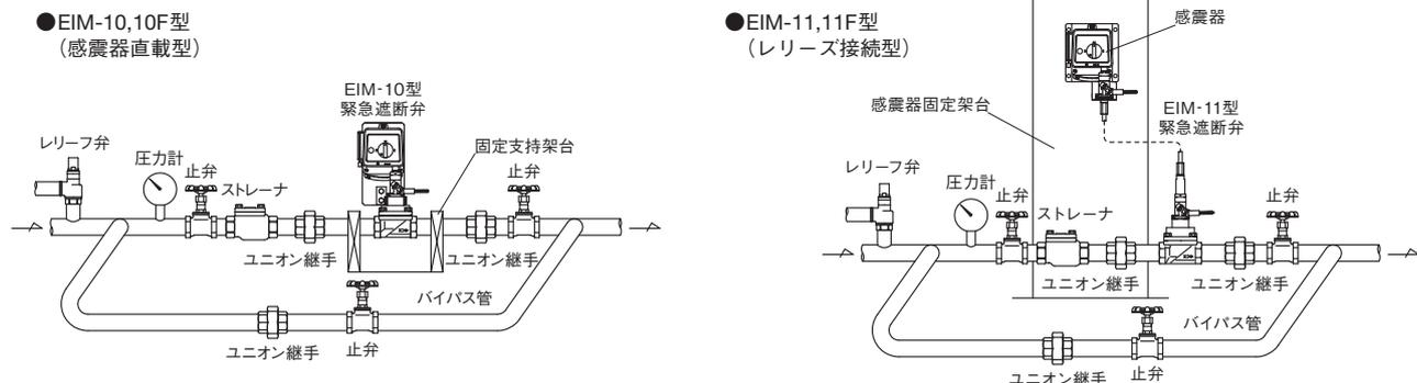
1. 感震器直載型は感震器が遮断弁に直に組付けとなっているため、地震以外の配管の振動（ハンマー現象など）で作動する恐れがあります。
