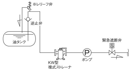
図3. 受水槽用緊急遮断弁配管例略図
