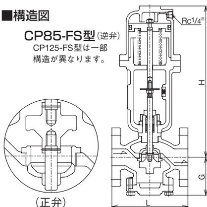
注. 操作空気供給孔JIS RC 3/8も製作しています。
