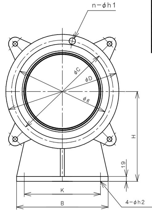
No. 13 のセットナットは、配管後緩め図示通り移動してください。
