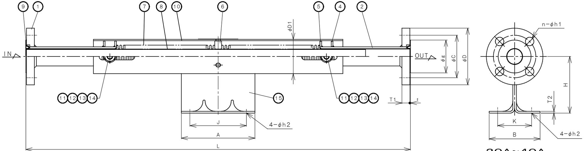
No. 12, 14 のナットA・ザガネは、配管後取り外してください。
