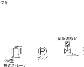
※液体用の場合、ハンマー現象や周囲温度による流体の熱膨張などで昇圧が予想される場合は、レリーフ弁を取り付けてください。
