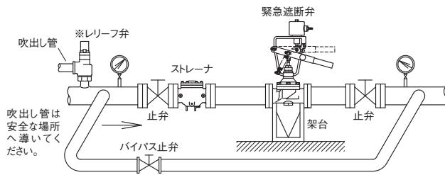
図2. 緊急遮断弁配管例略図
