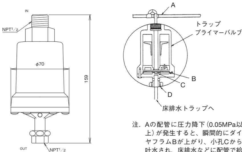
注. Aの配管に圧力降下(0.05MPa以上)が発生すると、瞬間的にダイヤフラムBが上がり、小孔Cから吐水され、床排水などに配管で給水される。
