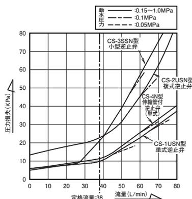
注. 挿入形管端コア使用時で、流量38L/min以上の場合の圧力損失は、上記線図から読みとった圧力損失より0.005MPa多くなります。
