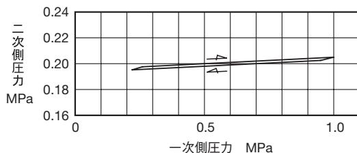
一次側圧力0.5MPaの時、二次側圧力を0.2MPaに設定後、一次側圧力を0.5~1~0.22~0.5MPaに変化させた時の二次側圧力の変動を示します。
