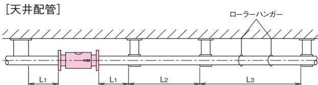
注. ローラーハンガーのみの設置では、配管が挫屈を起こします。必ずガイドを設置してください。
