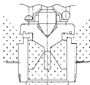
内圧が設定圧力よりも低い場合は、内圧による荷重よりもチョウセツバネ荷重が強いためにベンタイは閉止しています。
