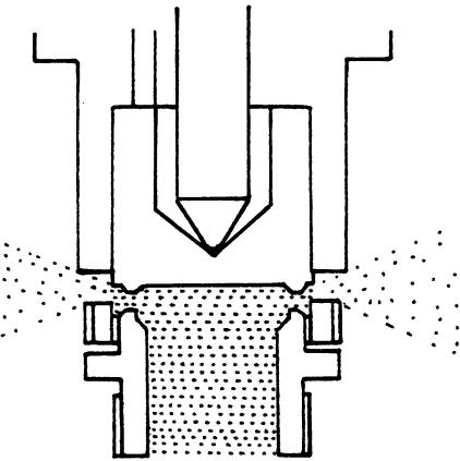
内圧が設定圧力よりも低い場合は、内圧による荷重よりもチョウセツバネ荷重が強いために、ベンタイは閉止しています。
